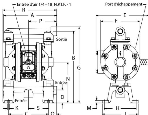
POMPE À MEMBRANE MÉTALLIQUE PD05X-XXX-B 1/2" (12,7 mm)
