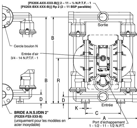
PX20X-XXX-XXX-C / PX20S-XXX-XXX-B() POMPE À MEMBRANE MÉTALLIQUE 2" (50,80 mm)
