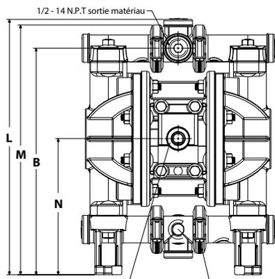
REMARQUE : Le desserrage de ces attaches va permettre à l'entrée / la sortie de tourner
